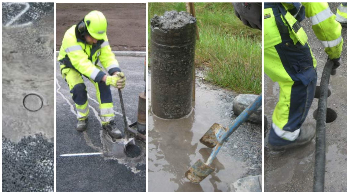
Figur 5.2 Lossbrytning, upptagning av provkropp samt städning. Dagens metod.
