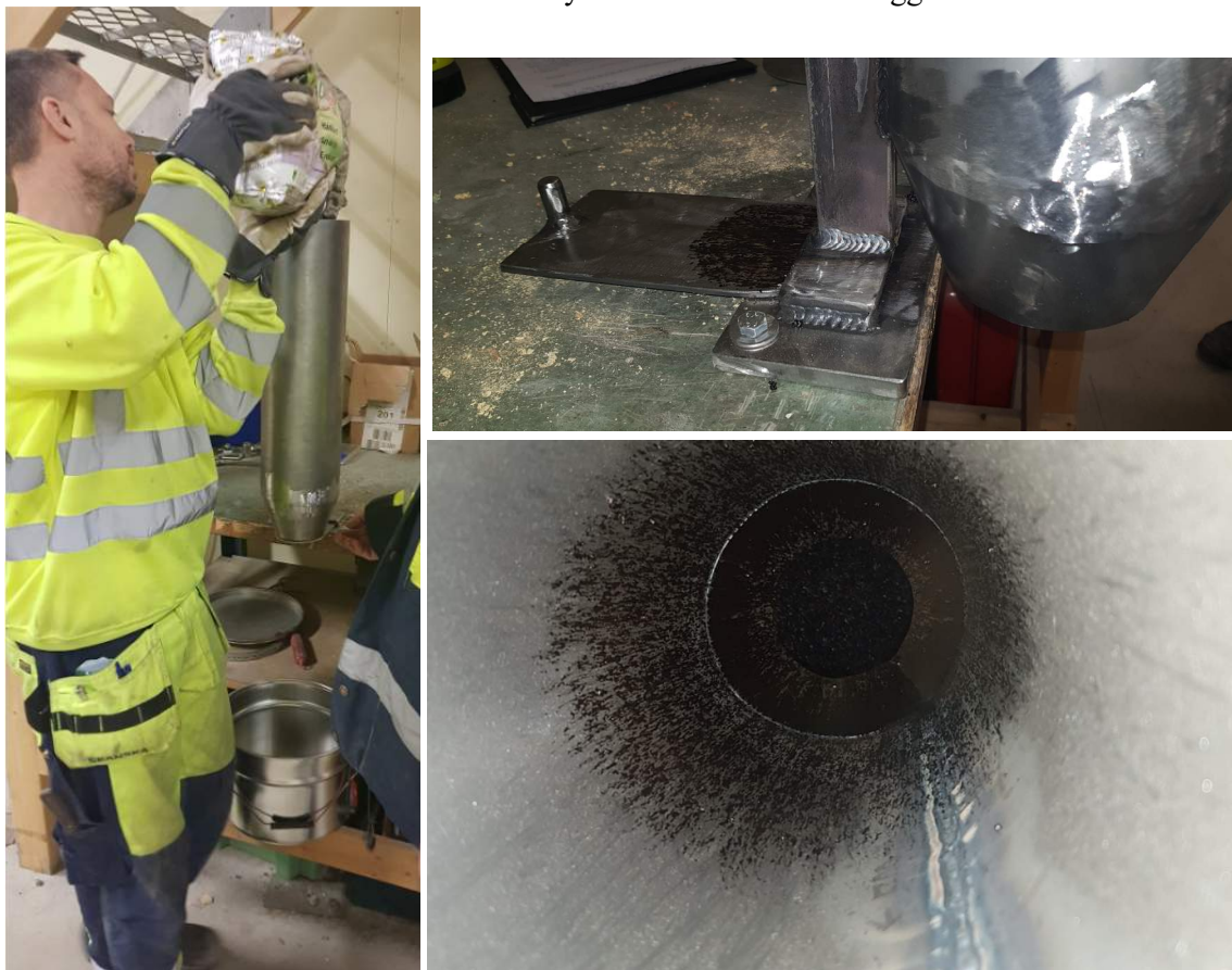
Figur 5.6 Praktiska tester med kallasfalt. Värt att notera att ytterst lite material fastnar i behållaren.
